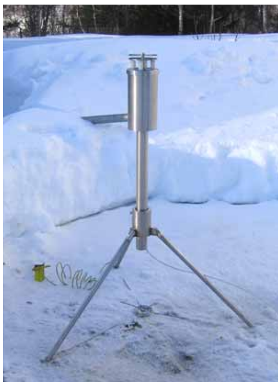
EFM, misuratore di elettricità terrestre
