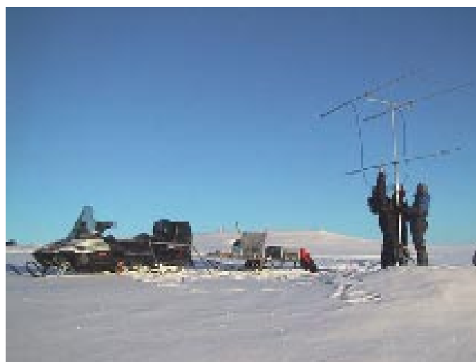
Radar UHF a bassa potenza che opera nella banda 420-450 Mhz
