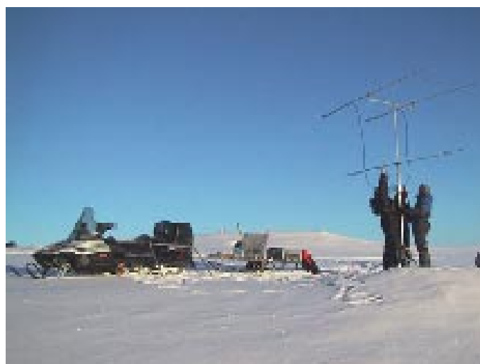
Radar UHF a bassa potenza che opera nella banda 420-450 Mhz
