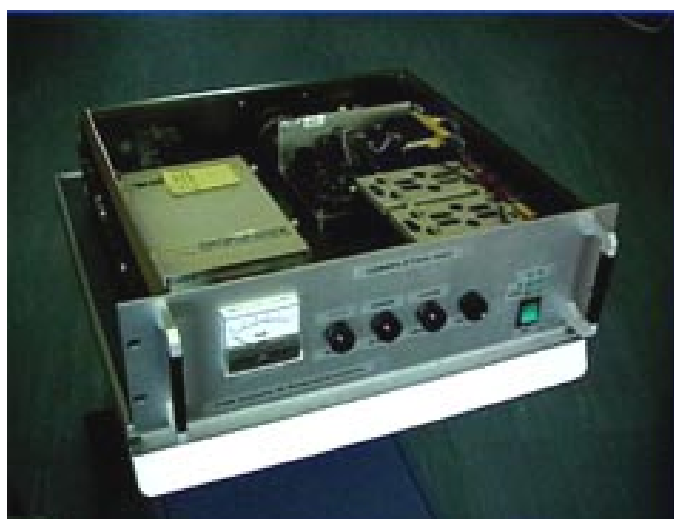
Ricevitore VLF denominato ELFO (Extremely Low Frequency Observatory) realizzato presso l'Istituto di Radioastronomia di Bologna. Il ricevitore a correlazione lavora da 100 Hz-22 kHz e utilizza due loop antenna di 2x2 m
