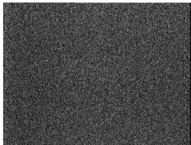
Foto 3: dark-frame della Watec 902H3 Supreme. L'eccessivo guadagno della telecamera, che la rende performante per la video sorveglianza in luoghi scarsamente illuminati, ne impedisce un valido utilizzo in applicazioni orientate alla cattura di bolidi ed eventi luminosi aleatori.
