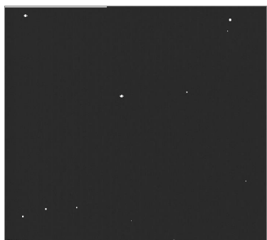
Foto 2: dark-frame della Mintron ottenuta nelle medesime condizioni della foto 1, ma con gli hot pixel marcati tramite il software UFOcapturePro.
